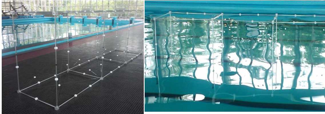
Figura 1 - Volume de calibração utilizado para as análises 3D similar ao descrito por Psycharakis et al. (2005).
