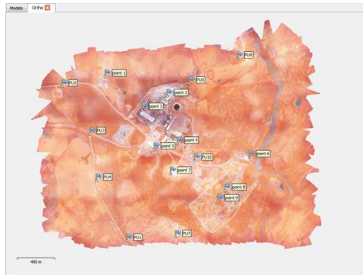
Figura 49 - Distribuição dos pontos de controle e ligação
