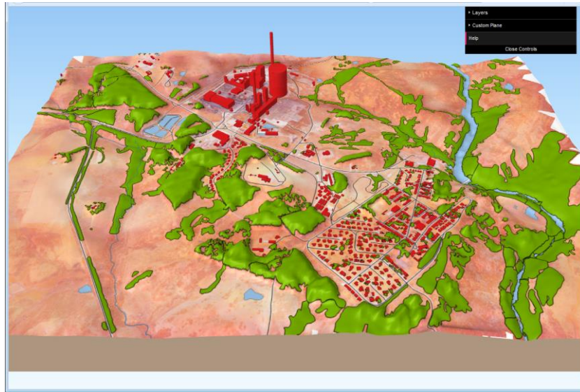
Figura 69- Mapa base tridimensional com a base do MDT gerado no Cloud Compare mais a vegetação
