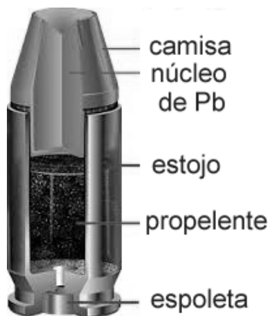
Figura 6: Cartucho de fogo central, mostrando esquematicamente a localização de projétil de chumbo encamisado, estojo, propelente e espoleta.
