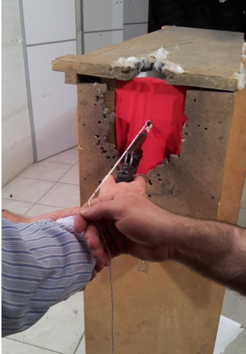
Figura 8: Disposição da arma e do anteparo com tecido para disparos em diferentes distâncias, onde marcações no cordão foram utilizadas para estipular a distância entre a boca do cano da arma e o anteparo.
