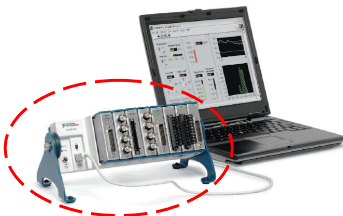
Figura 5 - Cartão de aquisição de dados - DAQ
