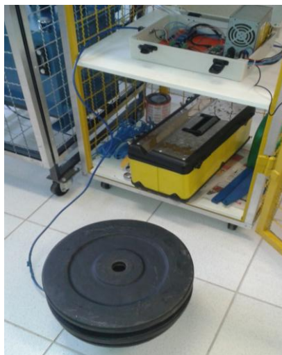
Figura 48 - Pesos empilhados sobre a célula de carga para calibração
