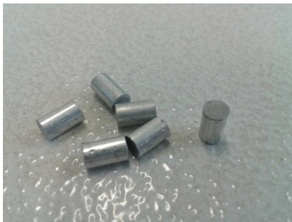
Figura 47 - Corpos de prova prontos para ensaio de compressão
