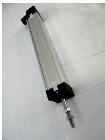
Figura 30 - Régua potenciométrica para medição da delocamento
