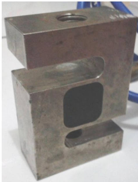
Figura 31 - Célula de carga Z 10KN
