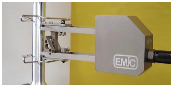
Figura 19 - Extensômetro acoplado ao corpo de prova para ensaio de tração
