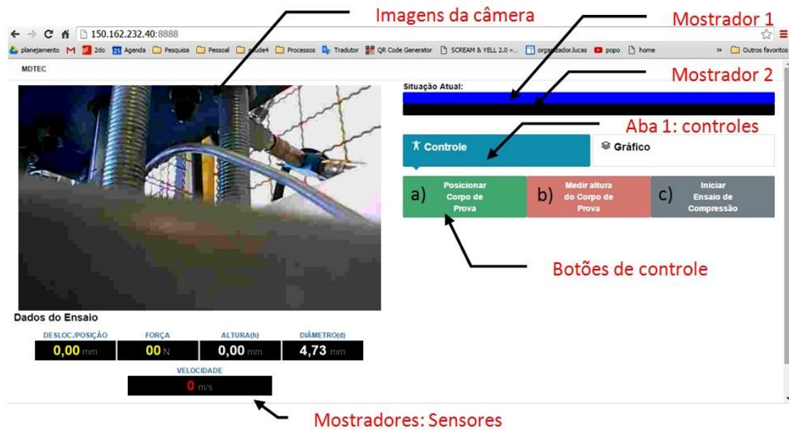
Figura 42 - Painel de controle da MDTEC (Vista aba controle)
