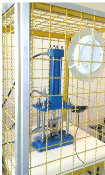
Figura 27 - Máquina Didática Teleoperada de Ensaio de Compressão (MDTEC)
