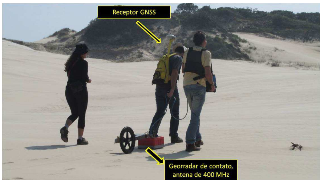
Figura 4 - Coleta de dados com Georradar (antena de contato) e Receptor GNSS acoplado.
