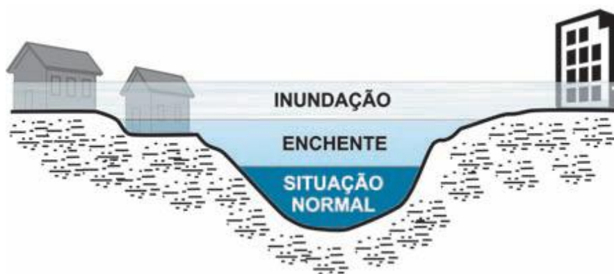
Figura 5: Perfil esquemático do processo de enchente e inundação. Fonte: Ministério das Cidades/IPT, 2007.
