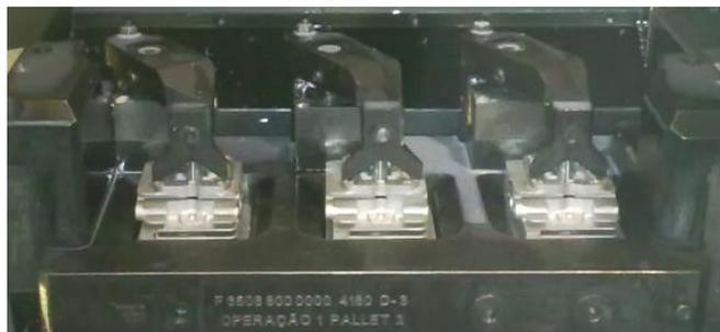
Figura 4.5 – Dispositivo de fixação das peças na máquina.
