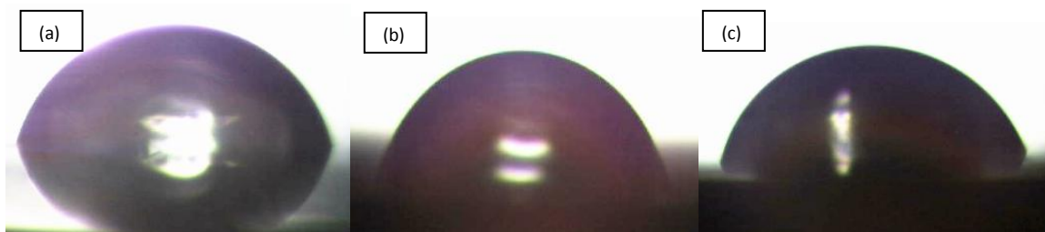
Figura 28- Imagem de ângulo de contato obtida para a liga AA2024 revestida com 90et 1TMSPM (a), 90et 2TMSPM (b) e 90et 3TMSPM (c).
