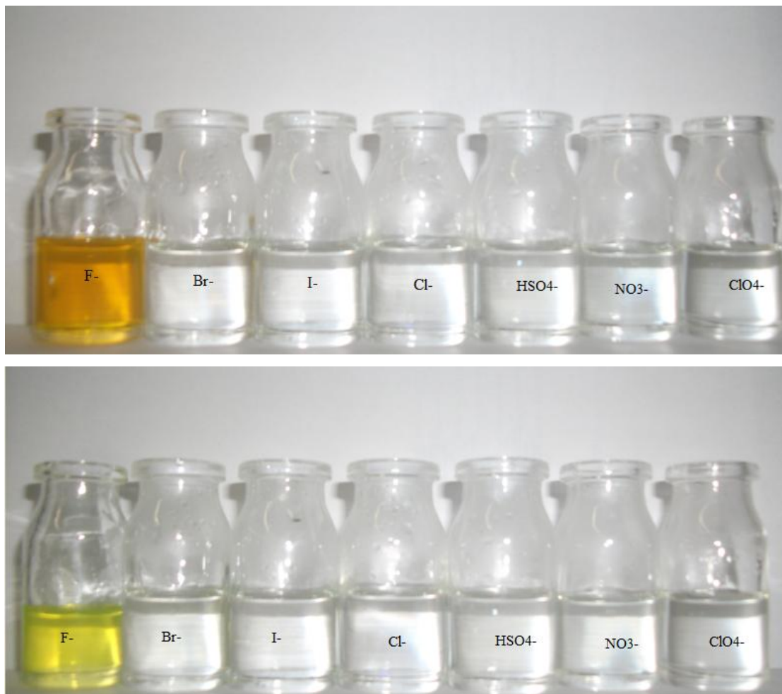
Figura 55. Avaliação visual da complexação dos compostos sintetizados com diferentes íons utilizando o composto 32 (acima) e o composto 33 (abaixo).
