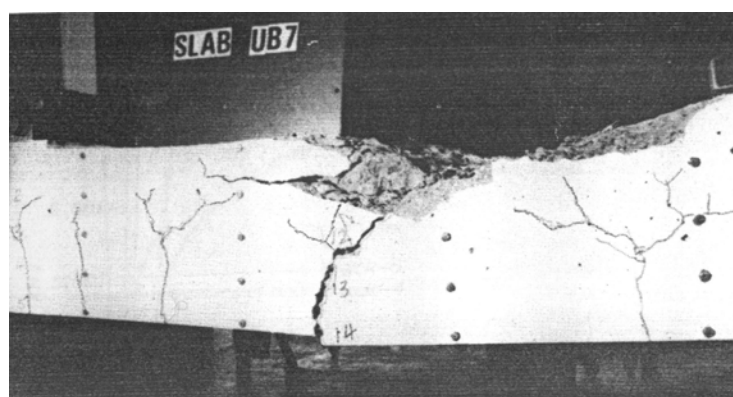
Figura 2.11 – Ruptura de laje de Cooke et al (1981) com alta taxa de armadura.
