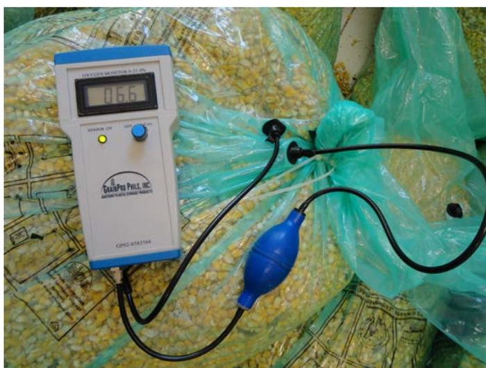
FIGURA 1. Bags com válvulas para medição da concentração de oxigênio. Fonte: Priscila Viebrantz. Porto Alegre, RS. 2013.
