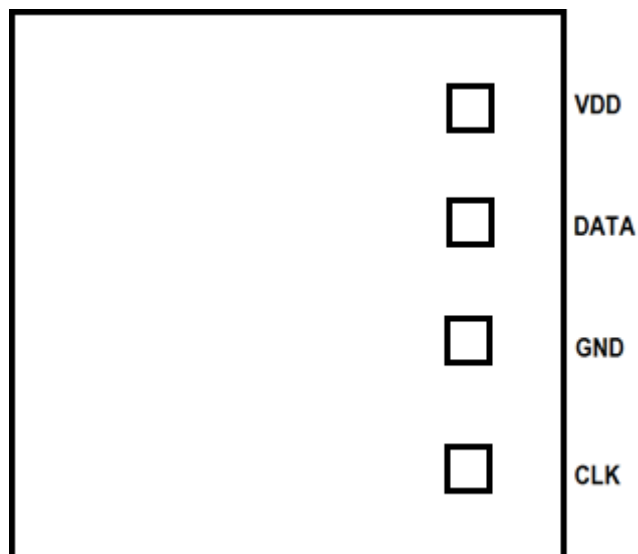
Figura 4.4 – Floorplan e terminais de teste do dispositivo IC2
