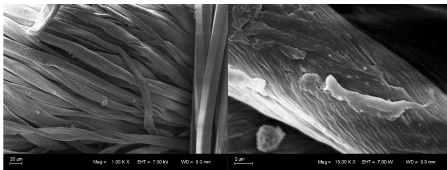
Figura 15: MEV do tecido hidrofílico à magnificação de 1000 (esquerda) e 15000 (direita).
