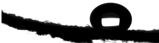
Figura 14: Ângulo de contato do tecido funcionalizado pela solução 1 após ciclo de lavagem.
