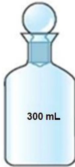
Figura 8 – Frasco de Winkler de 300 mL para determinação de \text{DBO}_5 .
