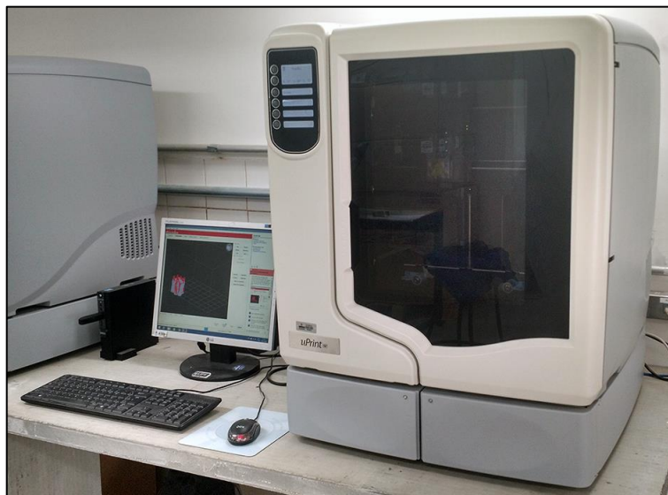
Figura 20 – Equipamento de impressão FDM uPrint™ SE.
