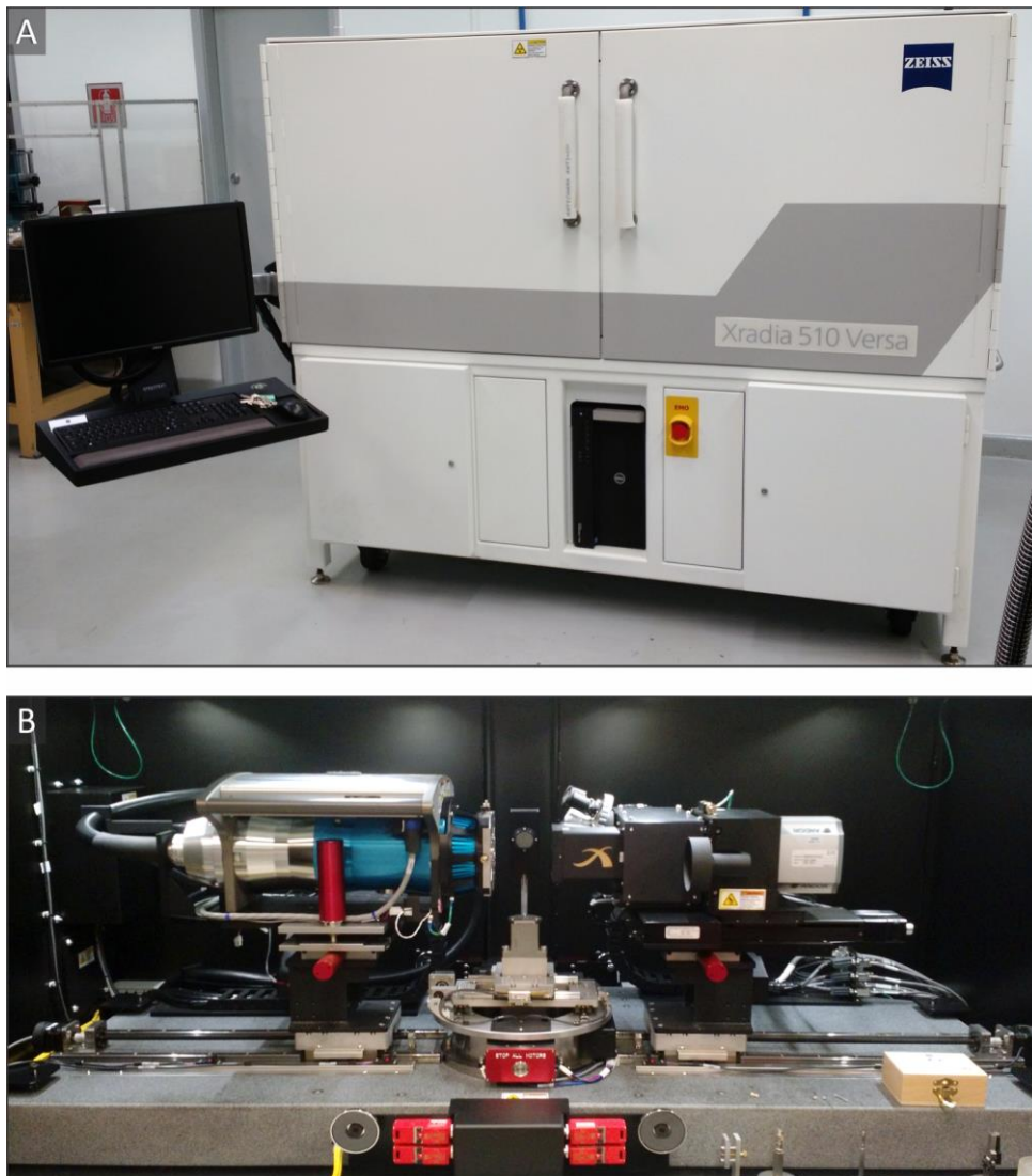
Figura 10 – Microtomografia computadorizada: (A) equipamento Xradia® 510 Versa e (B) detalhe do interior.
