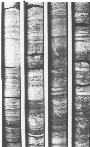
Figura 4.2: Exemplo de testemunho de sondagem.
