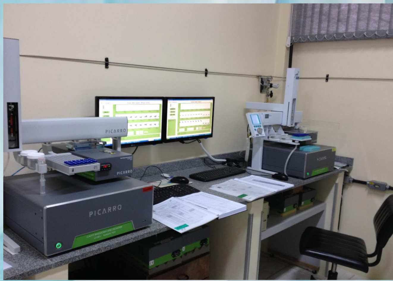
Figura 2. Espectrômetro a laser de cavidade ressonante tipo ring-down
