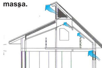
Figura 4: A diferença de pressão causada pelo forro angulado, persiana solar e pela clarabóia são uma das aplicações do Efeito Venturi e do Efeito Bernoulli na CasaE-UFRGS
