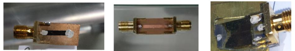
FIGURA (2): Linhas construídas para as medidas. (a) montagem para medida de magnetoimpedância, montagem para medida de permeabilidade (b) com stripline (c) linha coplanar em curto. As amostras são colocadas na superfície da linha.
