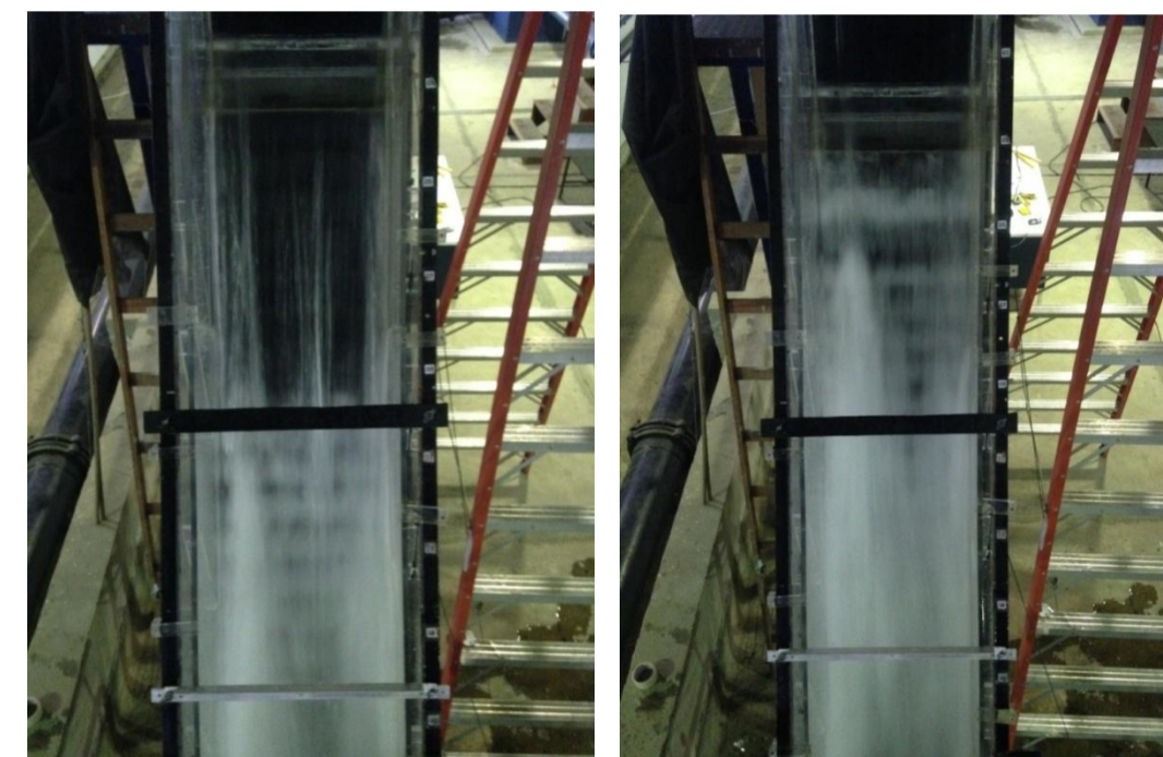
Vista Superior do Escoamento sobre o Vertedouro. (a) Escoamento sem Salto. (b) Escoamento com Salto
