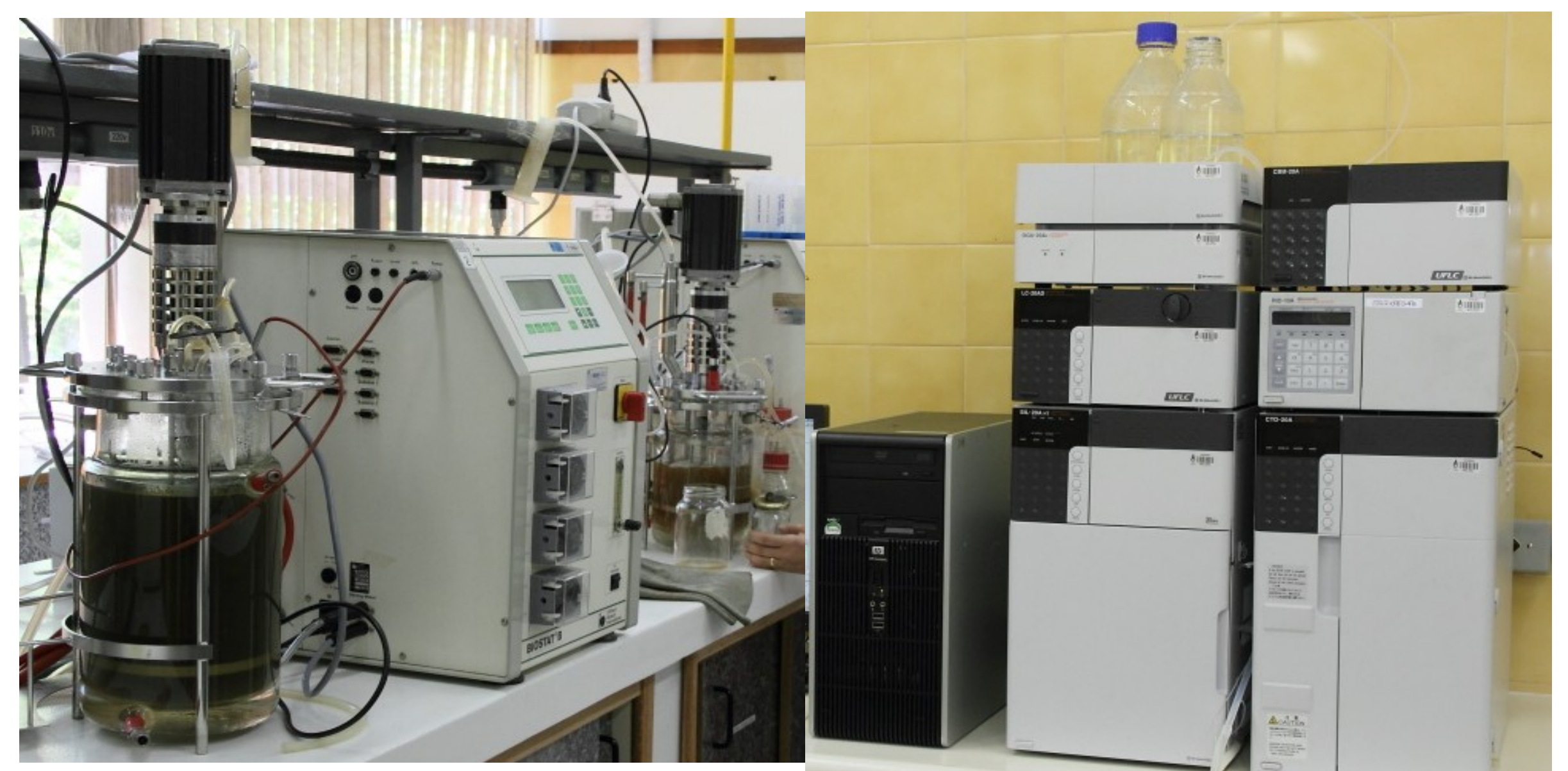
Figura 2: Biorreator e aparelho HPLC, usado para aferir as quantidades de diferentes açúcares produzidos.
