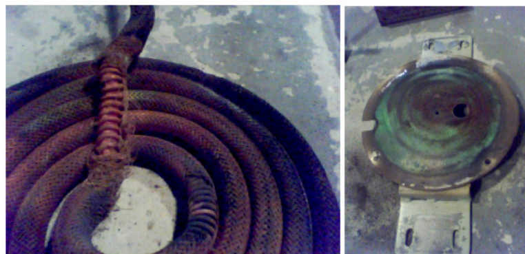
Figura 4.6. Sistema de resfriamento danificado devido à intensa oxidação durante a realização do experimento.
