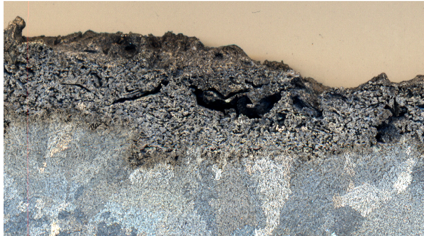
Figura 5.22. Detalhe da macrografia perto da superfície mostrando a influência da escória formada como substrato para nucleação e crescimento de grãos.
