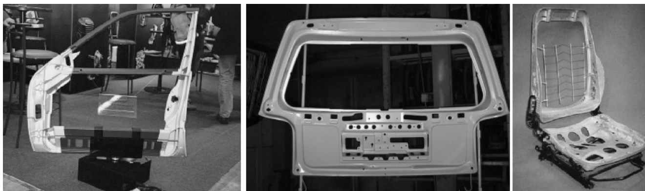
Figura 3.3. Peças automotivas projetadas em ligas de magnésio. Portas de carros lateral e traseira e armação de assentos. (R. Fink, 2003).
