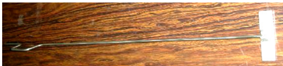
Figura 4.10. Dispositivo utilizado para agitação do banho.
