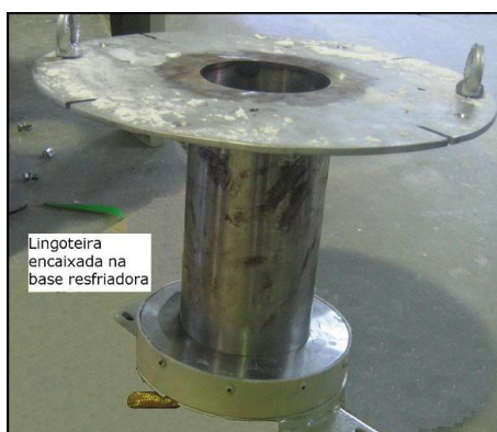
Figura 4.2. Conjunto cadinho e base do sistema de resfriamento.
