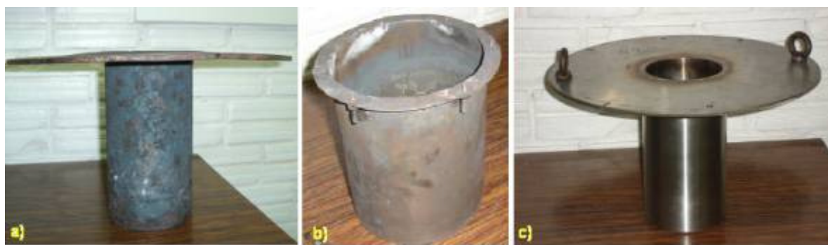
Figura 4.5. a) Formação de “carepas” no cadinho SAE1020, b) Chapa de aço inox 304 utilizada em volta do cadinho para proteger as resistências, c) Cadinho alternativo construído em aço inoxidável 420.
