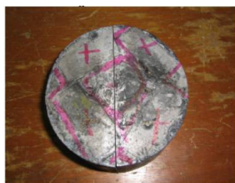
Figura 4.9. Parte inferior do lingote após a realização do experimento. Os pontos marcados com “x” correspondem à parte da carga que não fundiu.
