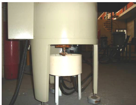
Figura 4.8. Sistema de resfriamento alternativo: água entrando em contato direto com a parte inferior da base.
