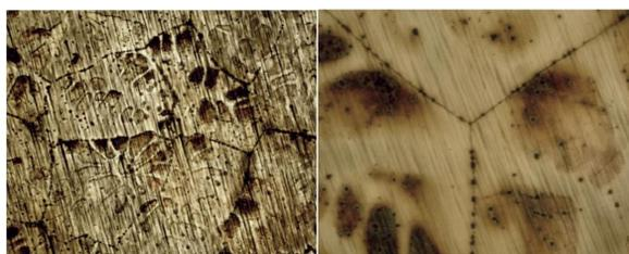
Figura 1 : (a) microestrutura da amostra ZK30 – aumento 400X (b) microestrutura da amostra ZK60 – aumento 1000X.
