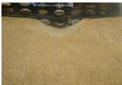
Figura 4 - Vista de topo da soleira da barragem, formato da cava após ensaios com areia.
