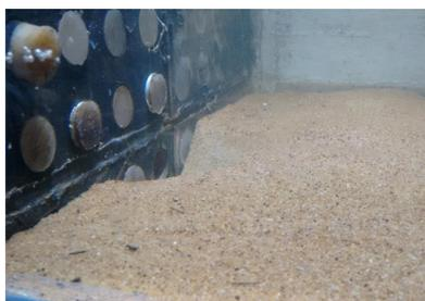
Figura 3 - Vista lateral após o ensaio de remoção do material, cava de areia formada pelo descarregador de fundo.
