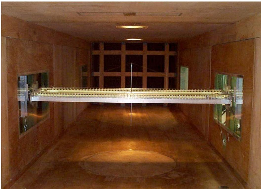
**Fig. 4.2 – Modelo seccional de escala 1:50 da Ponte Guamá (Rocha et al, 2001).**
