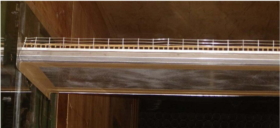
**Fig. 4.23 – Modelo PCN, chapa adicionada na face inferior da PON para fechamento em forma de caixão trapezoidal.**
