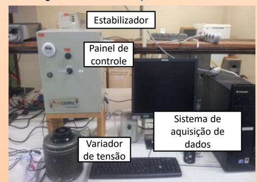
Figura 2 - Gerador de campo elétrico e sistema de aquisição de dados.
