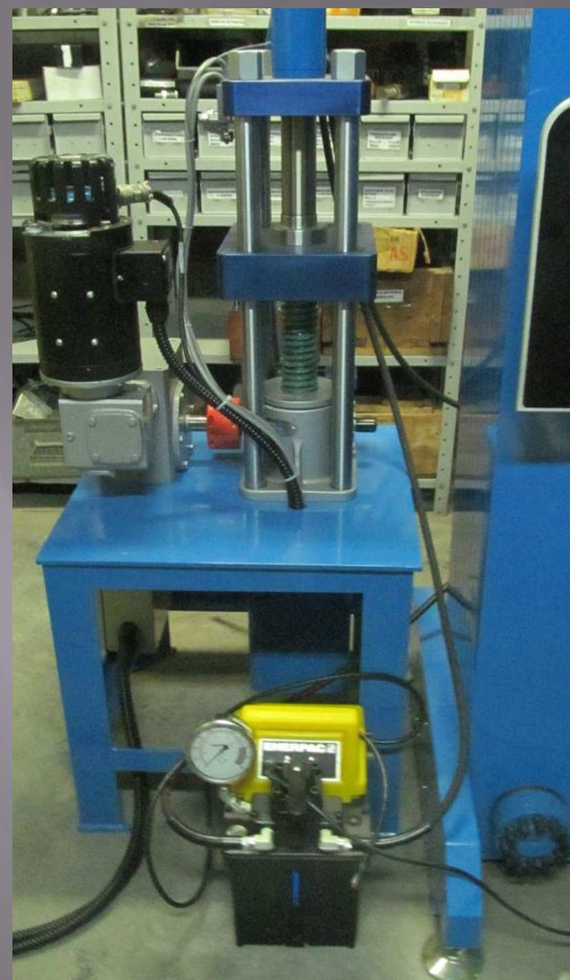
Acionador de pressão e bomba de óleo.
