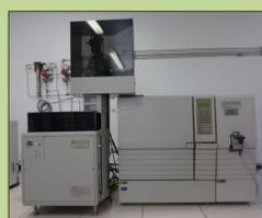
Cromatógrafo a gás acoplado a Espectrômetro de massas
