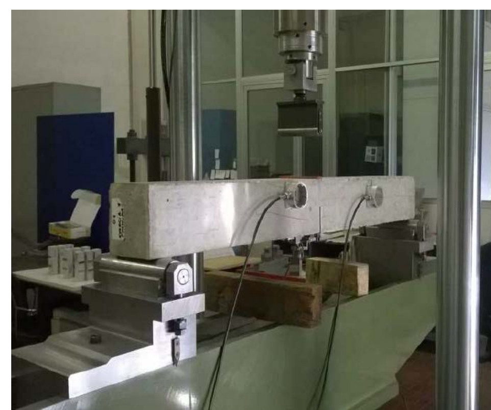
Figura 3: Ensaio de três pontos em viga de concreto com fenda na seção central. (Carpinteri et al)
