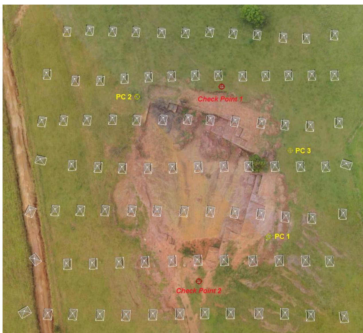
Figura 2 – Visualização dos PC's, Check Points e pontos de coleta de imagens feitos pelo VANT.
