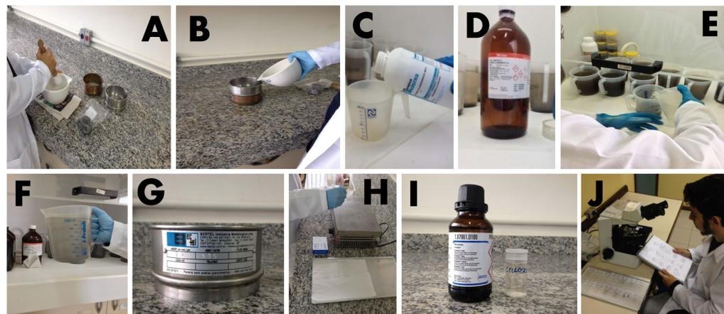
Fig 2: Processamento laboratorial. A e B: Desagregação física; C e D: Dissolução química utilizando HF e HCl; E: Lavagem; F: Decantação da matéria orgânica preservada; G: Peneira utilizada; H: Preparação das lâminas; I: Entellan e Cellosize; J: Análise das amostras.
