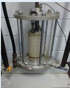
Figura 1 – Ensaio de Módulo Triaxial
