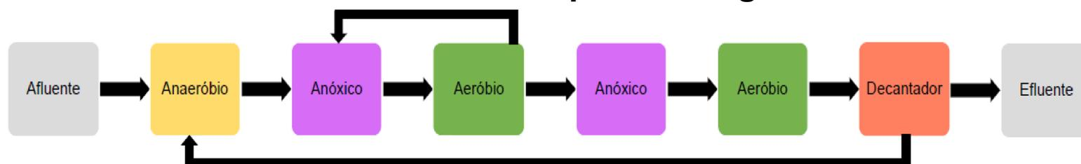
Esquema do processo Bardenpho 5-estágios (1°- Anaeróbio, 2°- Pré-Anóxico, 3°- Aeróbio, 4°- Pós-Anóxico, 5°- Aeróbio) alimentado ora por esgoto bruto, ora por esgoto pré-tratado por reator anaeróbio, com recirculação da câmara 3 para a câmara 2 e com recirculação do lodo sedimentado do decantador para a câmara 3
