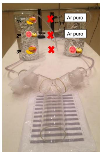
Figura 2. Olfatômetro em "Y" e a representação dos três bioensaios realizados.
