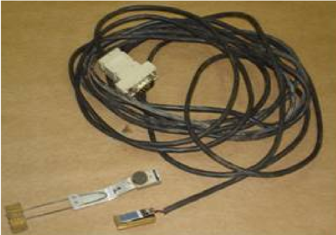
Figura 4.19: Transdutor de deformações específicas utilizando um sensor de efeito hall .
