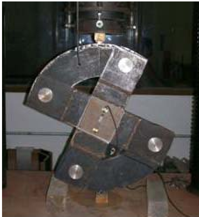
Figura 4.29: Ensaio de compressão biaxial APE – 02, posicionado para \sigma_2/\sigma_1 = -0,5/-1 .
