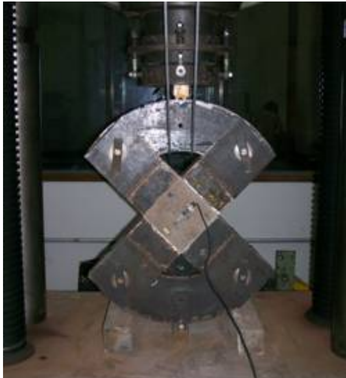
Figura 4.30: Ensaio de compressão biaxial APE – 02, posicionado para \sigma_2/\sigma_1=-1/-1 .
