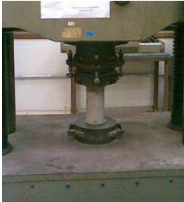
Figura 4.25: Ensaio de compressão simples.
