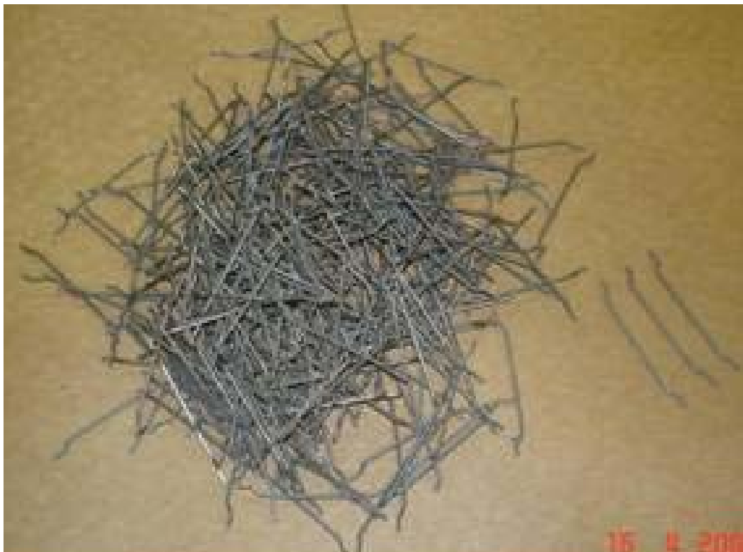
Figura 4.22: Fibras de aço utilizadas no Programa Experimental.
