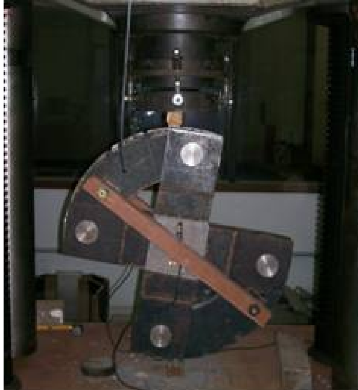
Figura 4.28: Ensaio de compressão biaxial APE – 02, posicionado para \sigma_2/\sigma_1 = -0,2/-1 .
