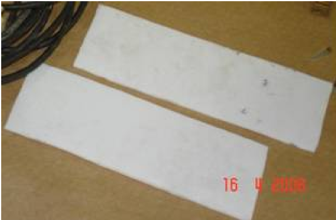
Figura 4.17: Lâminas de teflon utilizadas nos ensaios.
