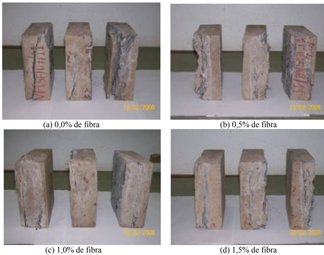
Figura 5.16: Modos de ruptura para \sigma_2/\sigma_1 = -0,5/-1 .
