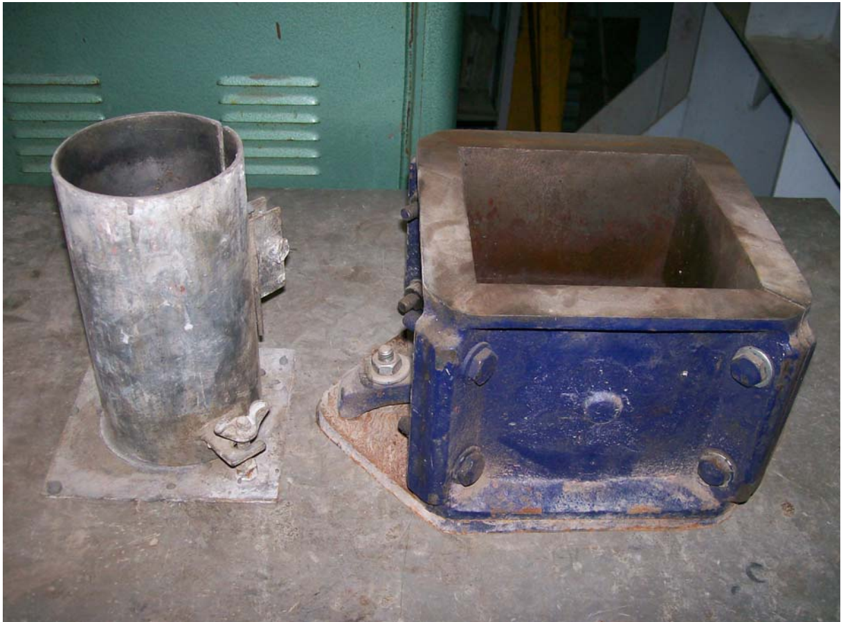
Figura 4.23: Fôrmas utilizadas para moldagem dos corpos-de-prova.
