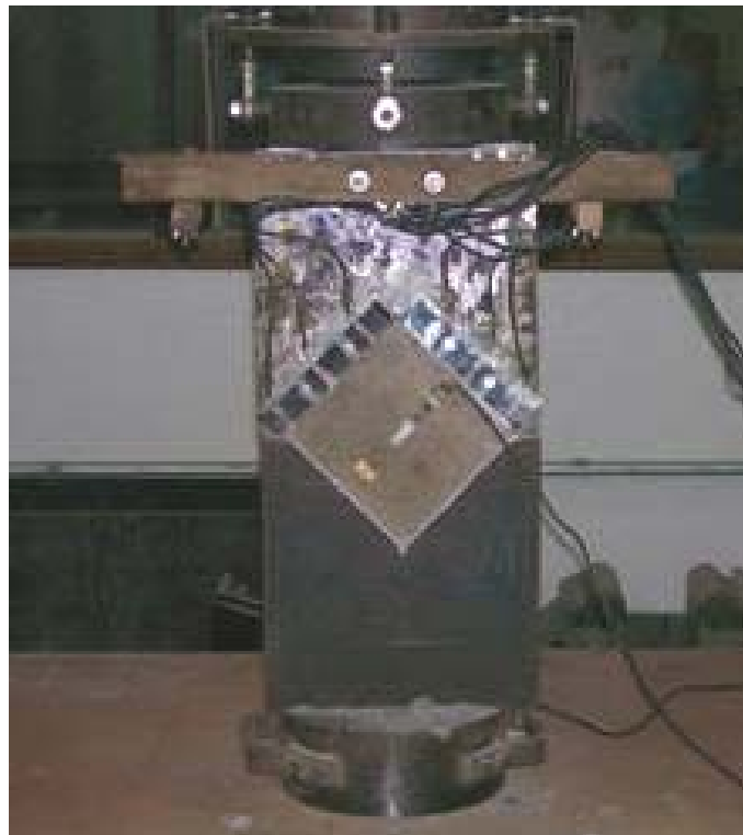
Figura 4.27: Ensaio de compressão biaxial APE – 01, para uma relação de tensão \sigma_2/\sigma_1 = -1/-1 .
