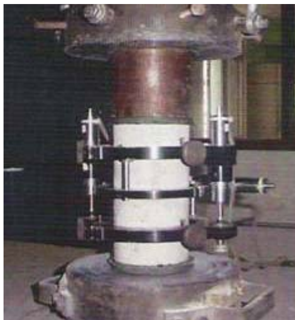
Figura 4.26: Instrumentação para obtenção do módulo de elasticidade.
