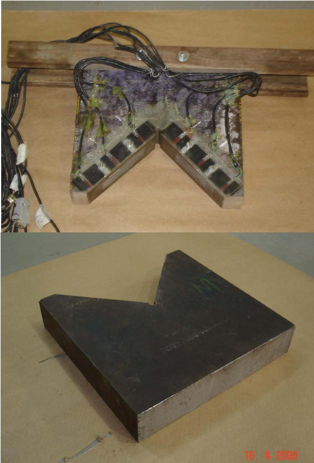
Figura 4.5: Detalhamento do APE-01.
