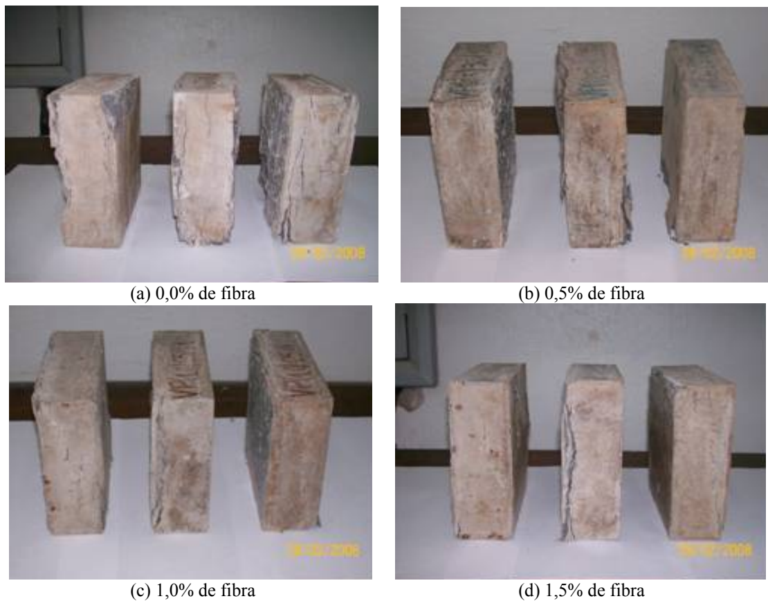
Figura 5.17: Modos de ruptura para \sigma_2/\sigma_1 = -1/-1 .
