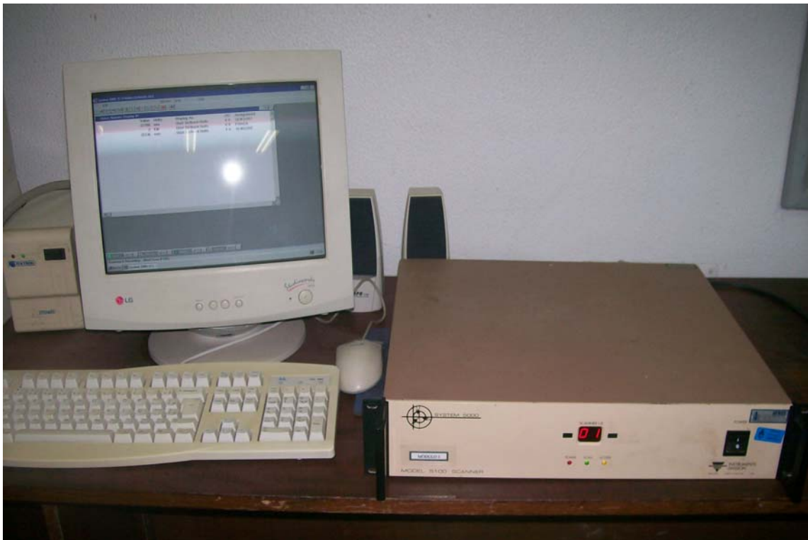
Figura 4.20: Sistema de aquisição de dados por computador SYSTEM 5000 .
