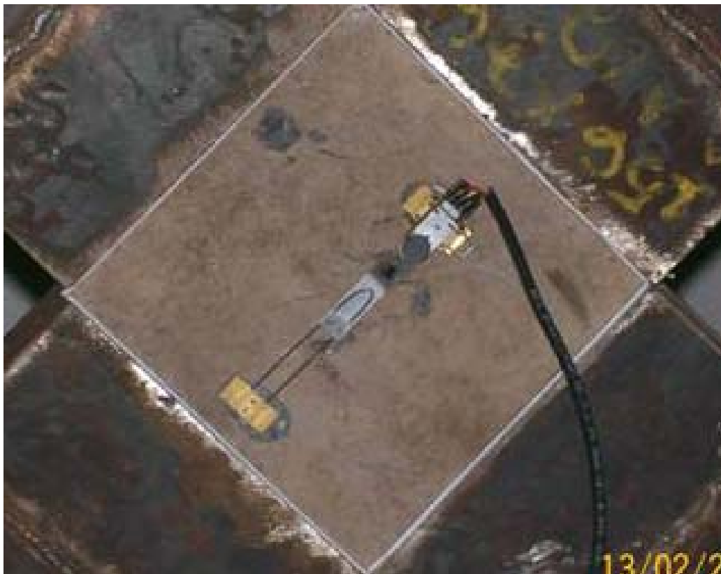
Figura 4.18: Sensor de efeito Hall posicionado em corpo-de-prova de concreto.
