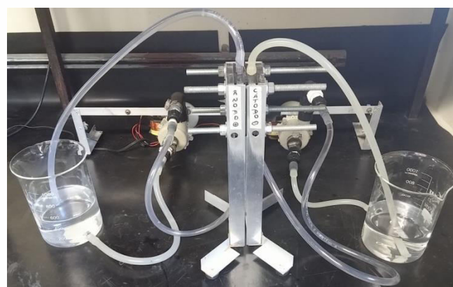
Figura 2. Célula de redução eletrolítica de dois compartimentos.
