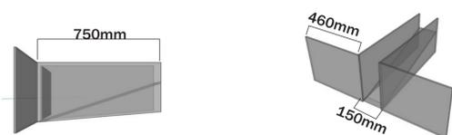
Figura 3: Modelo reduzido feito com acrílico com escala de 1:10
