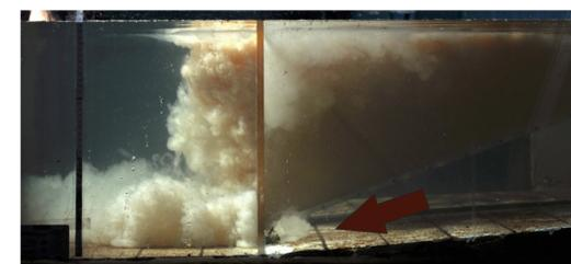
Figura 5, 6, 7: Sequência de fotos da corrente de turbidez se desenvolvendo dentro do modelo reduzido
