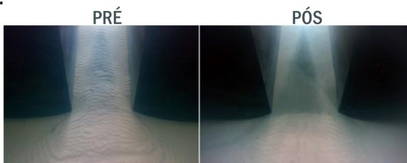
Figura 2: Região inferior do canal do tanque estratigráfico de grandes dimensões pré e pós deslizamento. (fonte: Richard Ducker)
