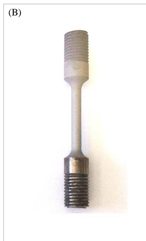
Figura 4.3: Representação com geometria e dimensões dos corpos de prova retangulares em (A), e imagem de corpo de prova usinado empregado no estudo em (B).
