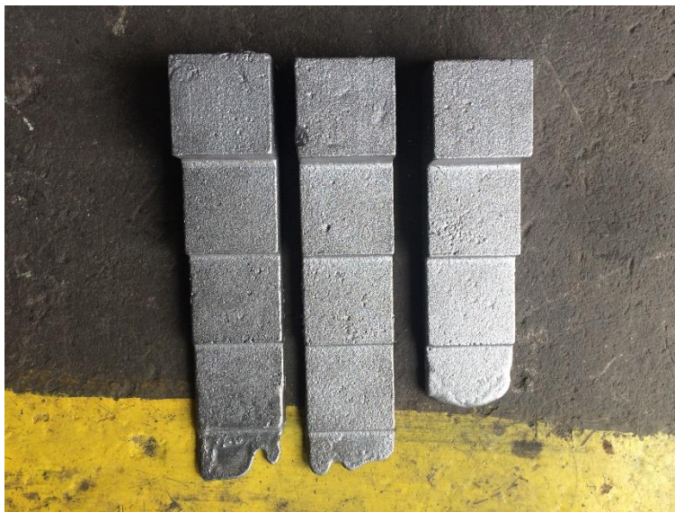
Figura 5.1 Corpos de prova obtidos com temperaturas de vazamento de 1593° C, 1583° C, 1573° C, respectivamente da esquerda para a direita.
