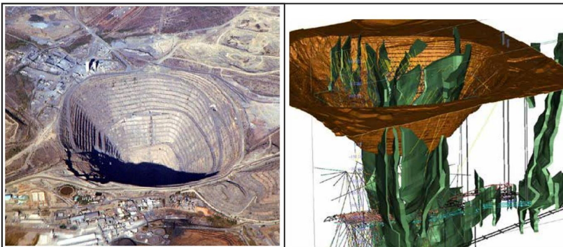
Figura 6. Vista aérea do pit e modelo geológico do depósito de Palabora com a projeção dos corpos de minério e da mina subterrânea (fonte internet, http://www.3ds.com/customer-stories/single/palabora-copper/ (acesso em 21-09-2015)).
