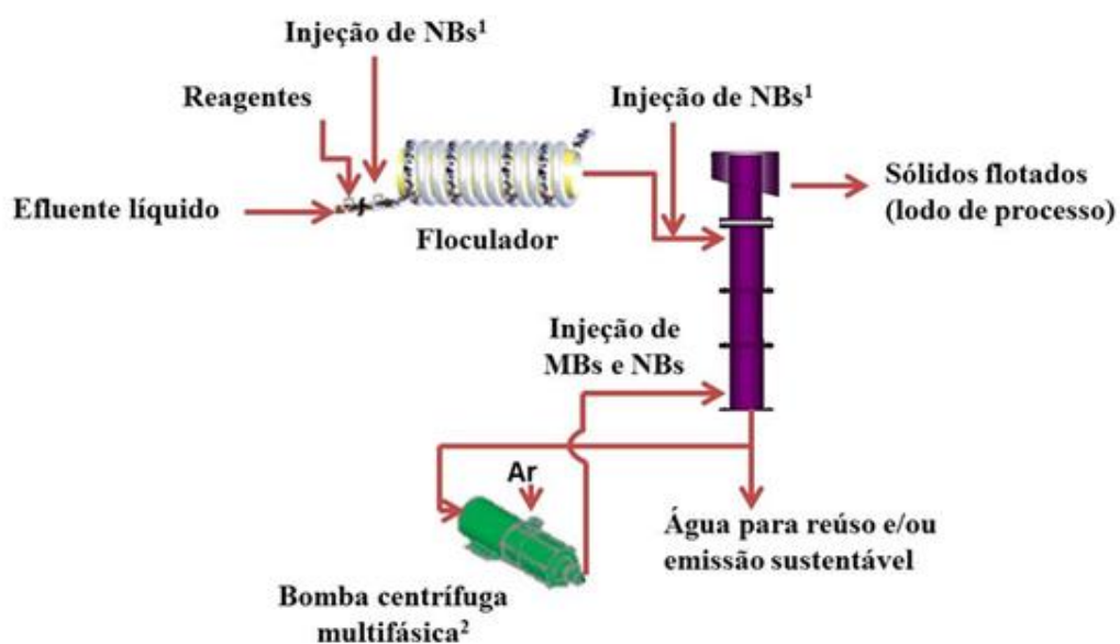
Figura 7.1. Fluxograma de processo de floculação-flotação para tratamento de efluentes líquidos com múltipla injeção de bolhas. 1 NBs geradas em vaso saturador com P_{\text{sat}} de 2 atm; 2 Geração conjunta de MBs e NBs em P_{\text{sat}} de 4 atm.
