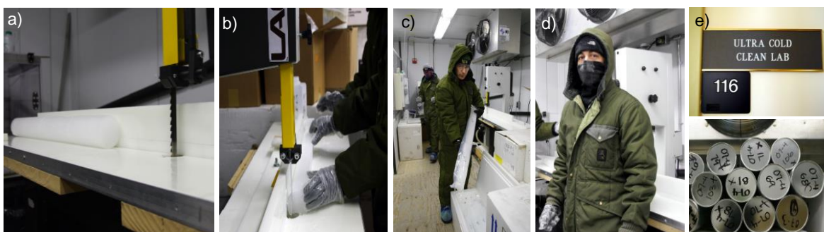
Figura 6: Atividades sobre a mesa de corte à -20^{\circ}\text{C} em 6a e 6b. Identificação, ordenamento estratigráfico e preparação para a descontaminação final das secções do testemunho de gelo BR MJ em 6c, 6d e 6e. Fonte: Fotografias do autor.
