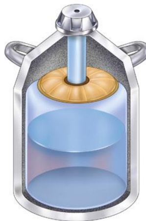
Figura 4: Esquema demonstrando o recipiente de armazenamento do criógeno. Contém tampa, tubo de pescoço, sistema de vácuo, parede dupla de metal e sistema de isolamento. Fonte: PASQUALI, 2015.
