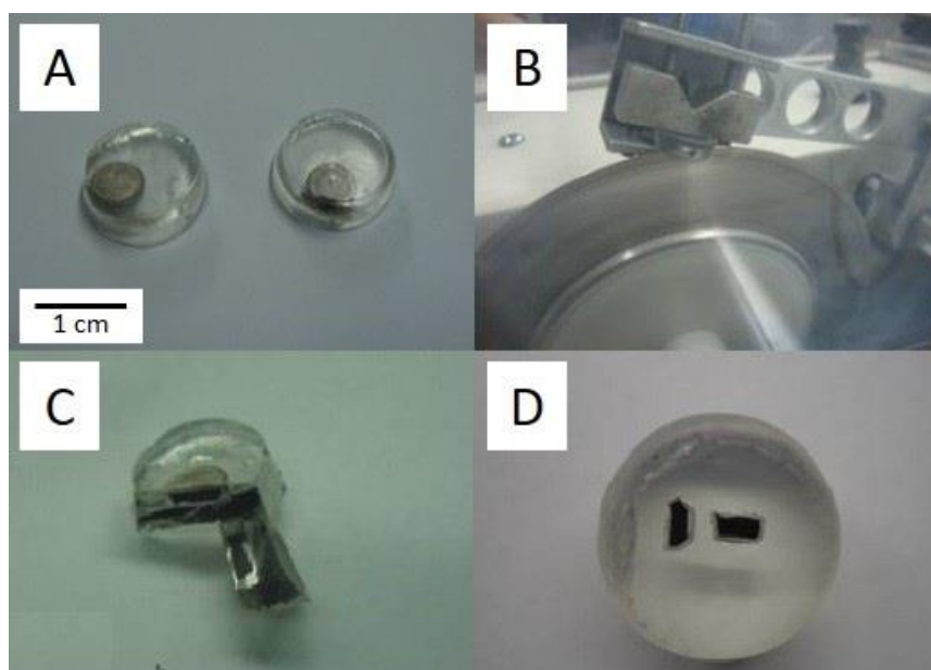
Figura 9: Esquema de preparação e corte de cápsulas: A) Pastilhas contendo as cápsulas processadas; B) Serra utilizada nos cortes; C) Pastilhas cortadas; D) Seção polida preparada para análise em MEV.
