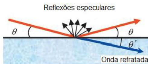
Figura 47 – Reflexão e refração de raios X na superfície de uma amostra. Adaptado de [127].
