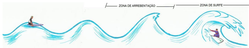
Figura 1. A velocidade com que a onda se propaga diminui quando ela passa por trechos mais rasos.
