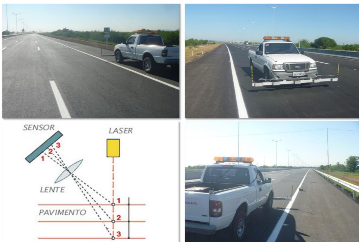
Figura 32 – Avaliação de irregularidade longitudinal com Perfilômetro Inercial Laser
