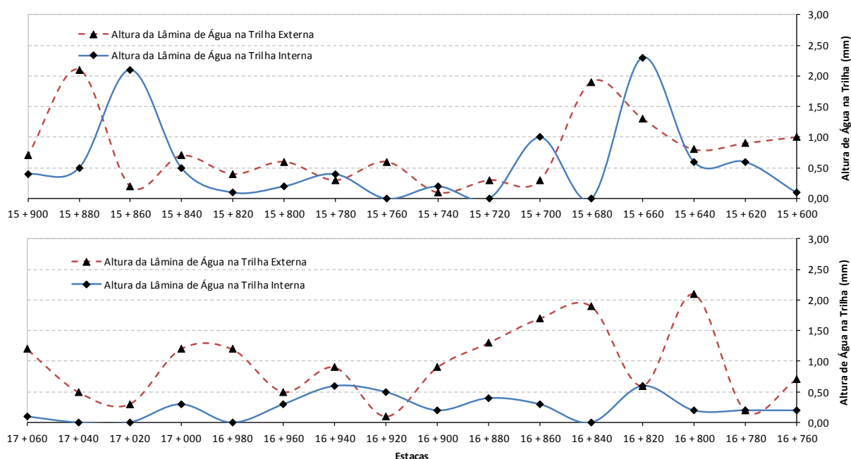
Figura 121 – Altura da lâmina de água nas trilhas de roda Trecho 1 e Trecho 2 BR-448/RS
