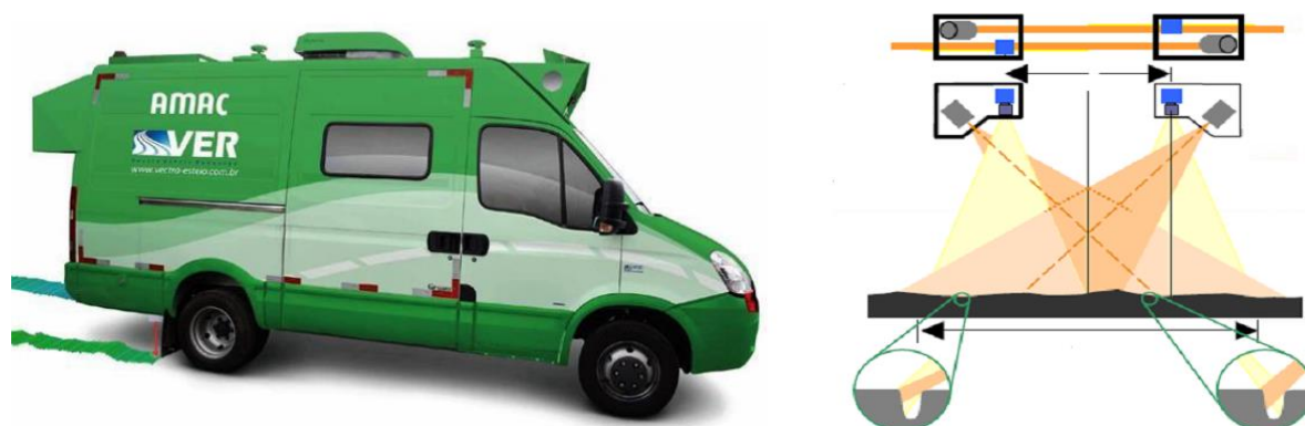
Figura 122 – Ilustração do equipamento AMAC e do funcionamento dos sensores laser
