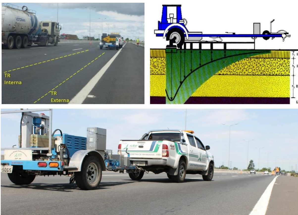
Figura 37 – Avaliação estrutural através de equipamento FWD- Falling Weight Deflectometer
