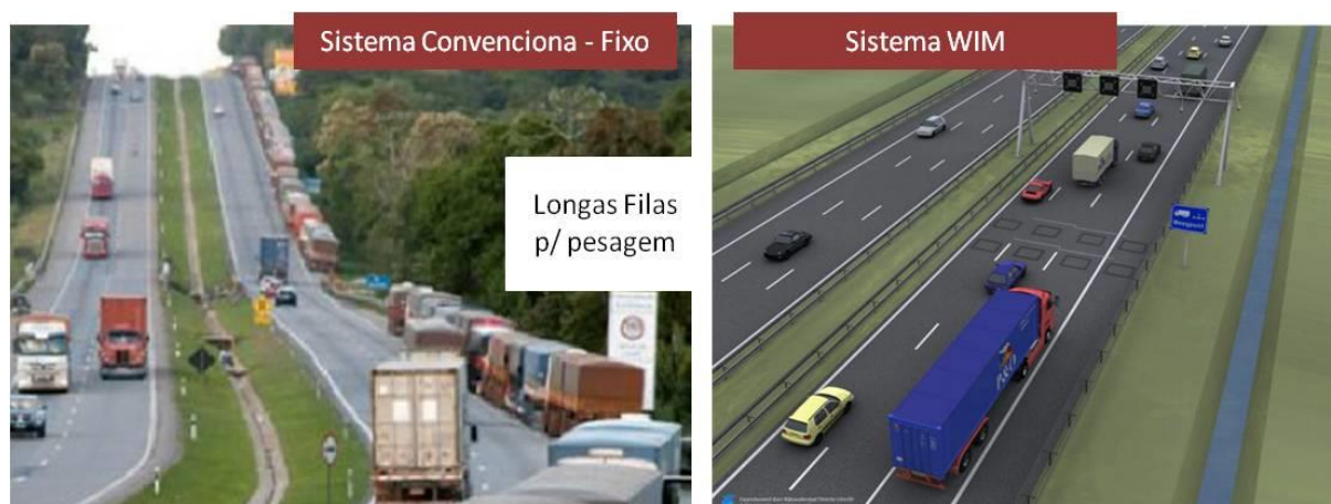
Figura 13 – Comparativo entre sistemas convencionais de pesagem (fixos) e sistemas de pesagem dinâmica (Weigh-in-Motion HS-WIM)
