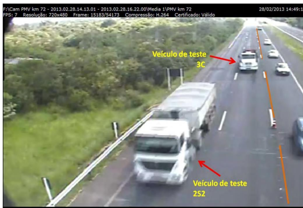
Figura 50 – Aproximação simultânea dos dois veículos de teste (2S3 e 3C) para pesagem em movimento na velocidade diretriz da rodovia (Fonte: Câmera do Sistema WIM)
