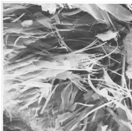
Figura 2.1: fotomicrografia da pasta de cimento Portland endurecida (INGLES e METCALF, 1972)
