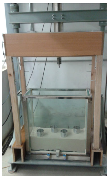
Figura 3.18: aferição da densidade relativa no tanque de solos após a pluviação
