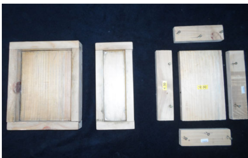
Figura 3.19: formas de madeira para moldagem da camada de reforço
