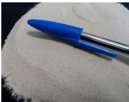
Figura 3.3: aspecto da amostra da areia utilizada - areia de Osório/RS
