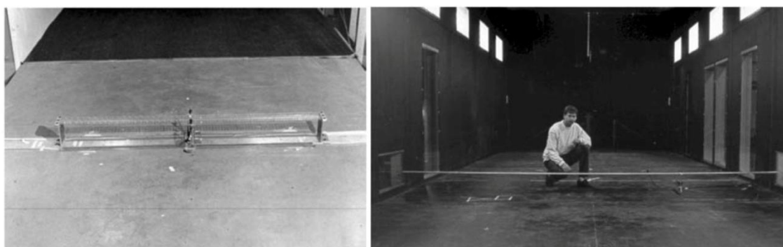
Figura 3.7 – Fotos dos modelos de faixa tensionada da ponte Bronx-Whitestone (esquerda) e da ponte Storebælt (direita) (King, 2003)
