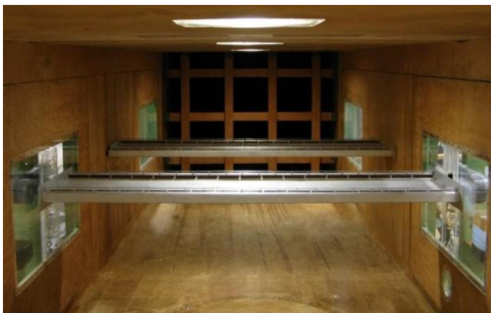
Figura 3.4 – Foto do modelo 1:50 da Ponte Octávio Frias de Oliveira conforme testado por efeitos de interferência de uma estrada adjacente do tabuleiro no Laboratório de Aerodinâmicas das Construções, Brasil (Nuñez, 2008)
