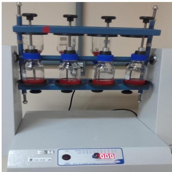
Figura 8. Ensaios de adsorção usando um agitador de Wagner e frascos schott. Fonte: presente estudo.
