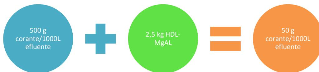
Figura 16. Esquema proposto para o tratamento hipotético de efluente contaminado com vermelho reativo 120 com base nos resultados experimentais obtidos no trabalho.
